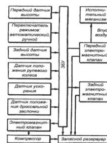
1.12 Сурет- Автомобиль аспасының қатаңдығын басқарудың құрылымдық схемасы
